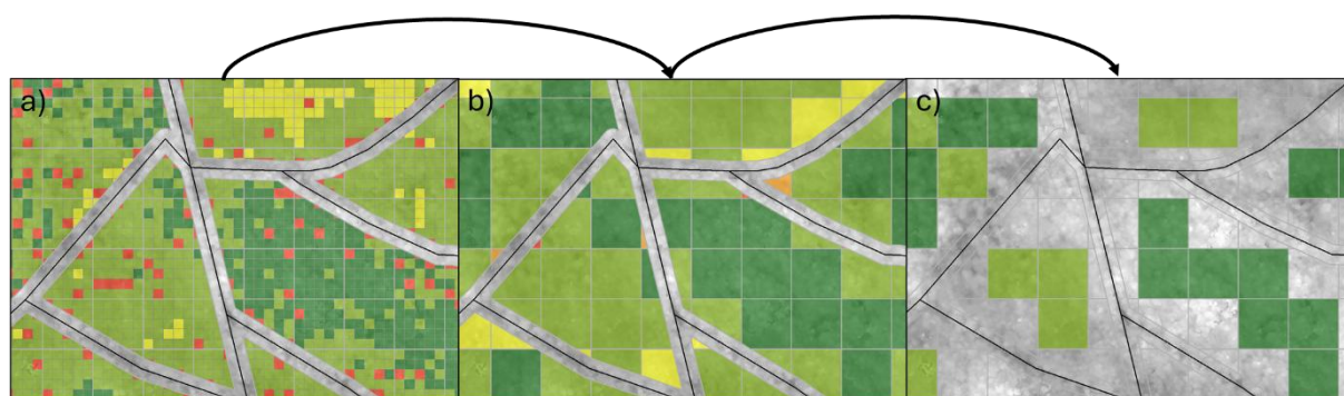
Rycina 4. Metodyka obliczania wysokości górnej (TH): a) wysokość maksymalna w oczkach 10 \times 10 m; b) utworzenie siatki 50 \times 50 m poprzez agregację 25 oczek 10 \times 10 m; c) włączenie oczek siatki 50 \times 50 m, które nie znajdowały się całkowicie w wydzieleniu, bez wchodzenia w granice bufora.
