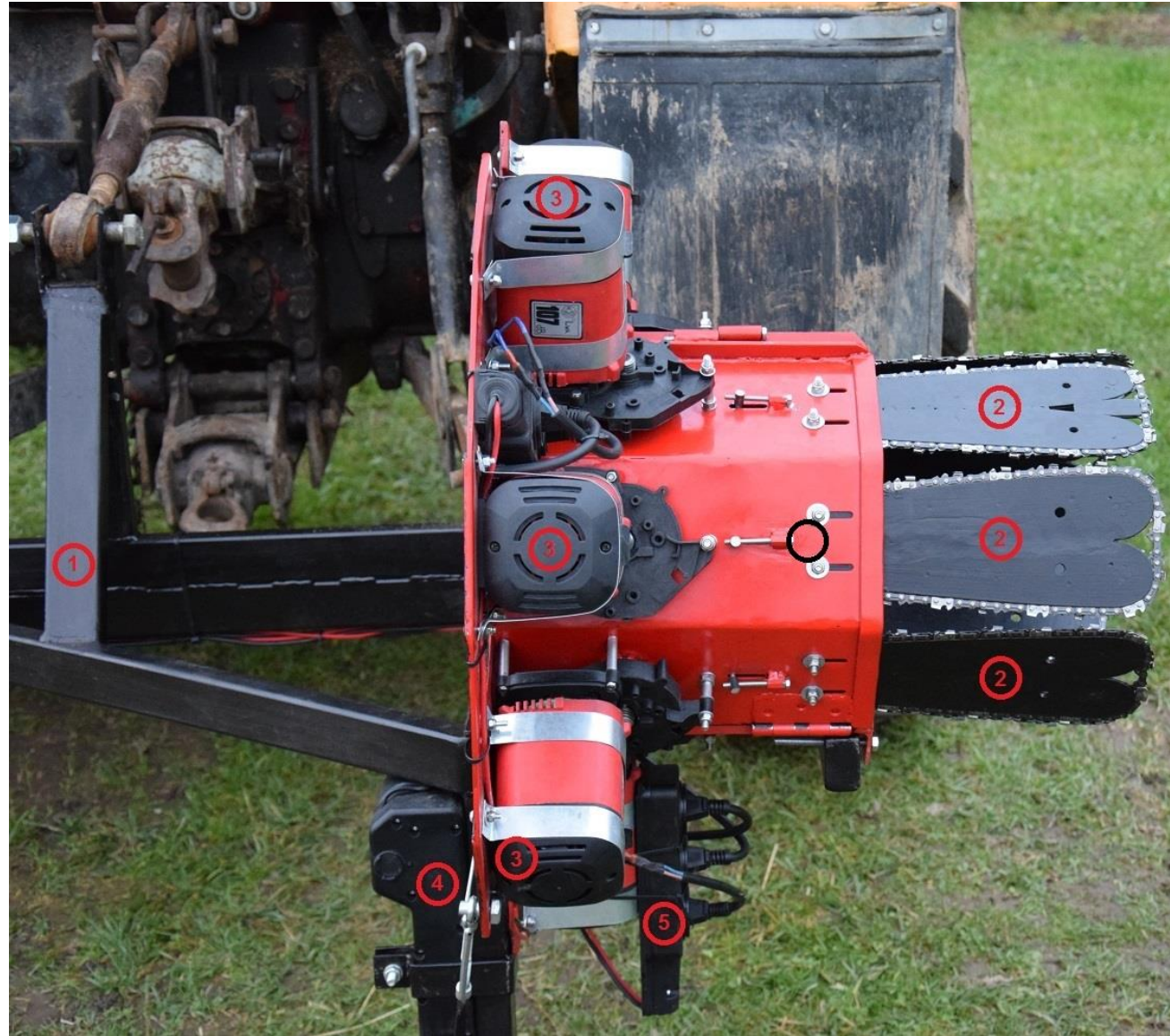
Ryc. 13. Głowica okrzesująca aktywnie GO-01 z oznaczonymi kluczowymi elementami układu: 1 – rama stalowa; 2 – zmodyfikowane prowadnice o szerokości około 12cm, z zamontowanymi na nich z łańcuchami tnącymi; 3 – silniki napędzające łańcuchy tnące; 4 – siłownik elektryczny, służący otwieraniu i zamykaniu sekcji bocznych głowicy (źródło: archiwum prywatne autora)
