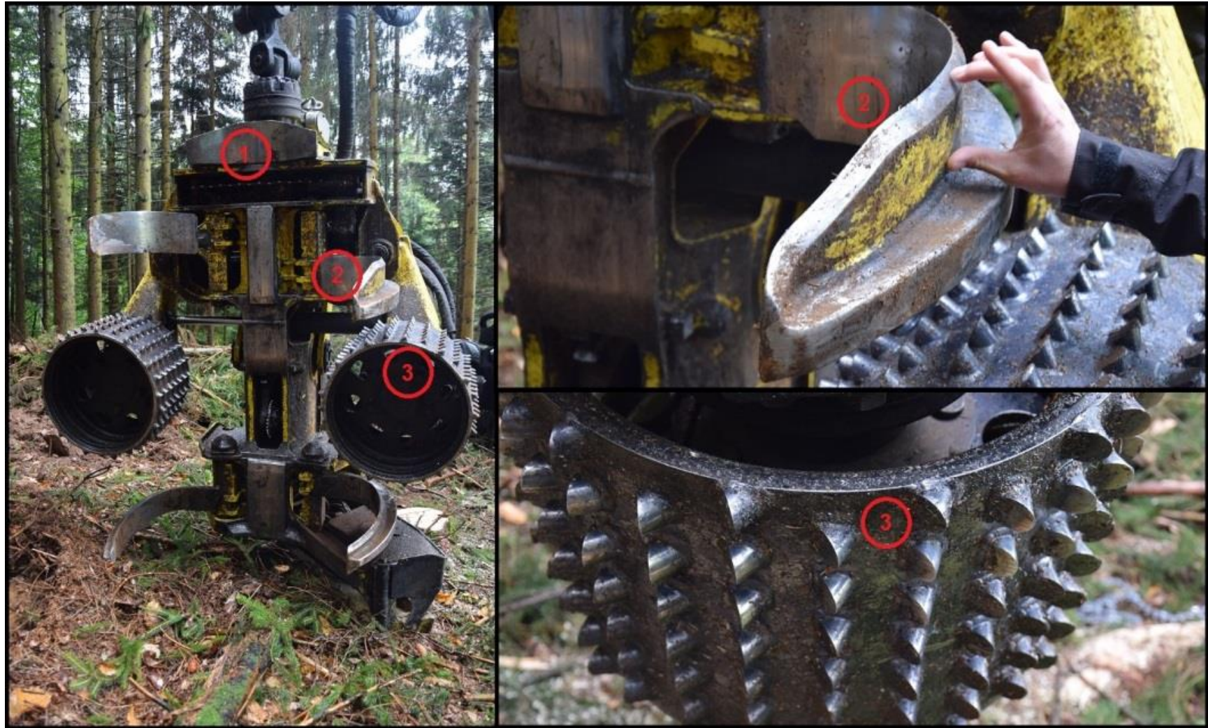
Ryc. 10. Głowica John Deere H290, przystosowana do pracy z surowcem liściastym: 1 - dodatkowa piła łańcuchowa w górnej sekcji ramy; 2 - noże okrzesujące o zwiększonej wysokości; 3 - rolki prowadzące o wydłużonych kołcach chwytynych (źródło: archiwum prywatne autora)
