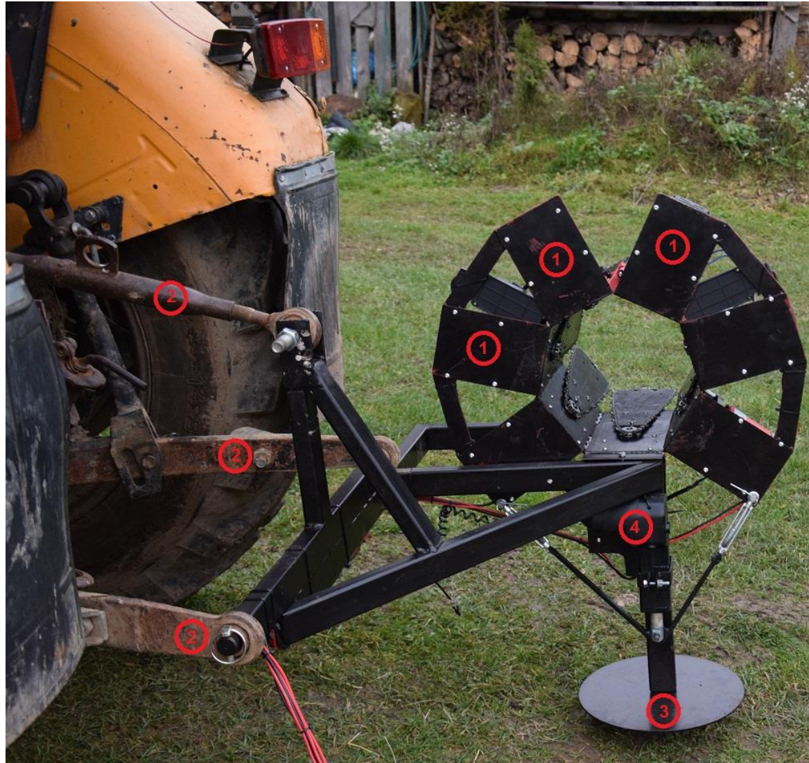
Ryc. 15. Widok zamkniętej głowicy okrzesującej aktywnie GO-01 od strony „wylotu” surowca drzewnego: 1 – podstawy silników napędzających łańcuchy tnące; 2 – cięgła trójpunktowego układu zawieszenia w ciągniku rolniczym; 3 – płyta oporowa zapobiegająca zapadaniu się układu w gruncie o niskiej nośności; 4 – silownik elektryczny, służący otwieraniu i zamykaniu sekcji bocznych głowicy (źródło: archiwum prywatne autora)
