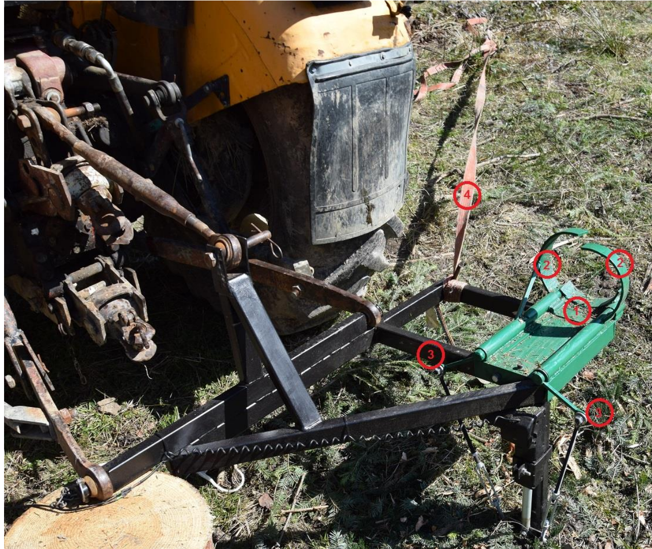
Ryc. 18. Głowica okrzyszująca surowiec drzewny w sposób pasywny GO-02, z widocznymi kluczowymi elementami jej konstrukcji: 1 – stały nóżokrzyszujący na dolnej stronie głowicy; 2 – półkolisty, ruchome noże okrzyszujące; 3 – ramiona służące do poruszania nożami z użyciem siłownika elektrycznego; 4 – dodatkowy pas stabilizujący cały układ (zapobiega przemieszczaniu całego traktora) (źródło: archiwum prywatne autora)
