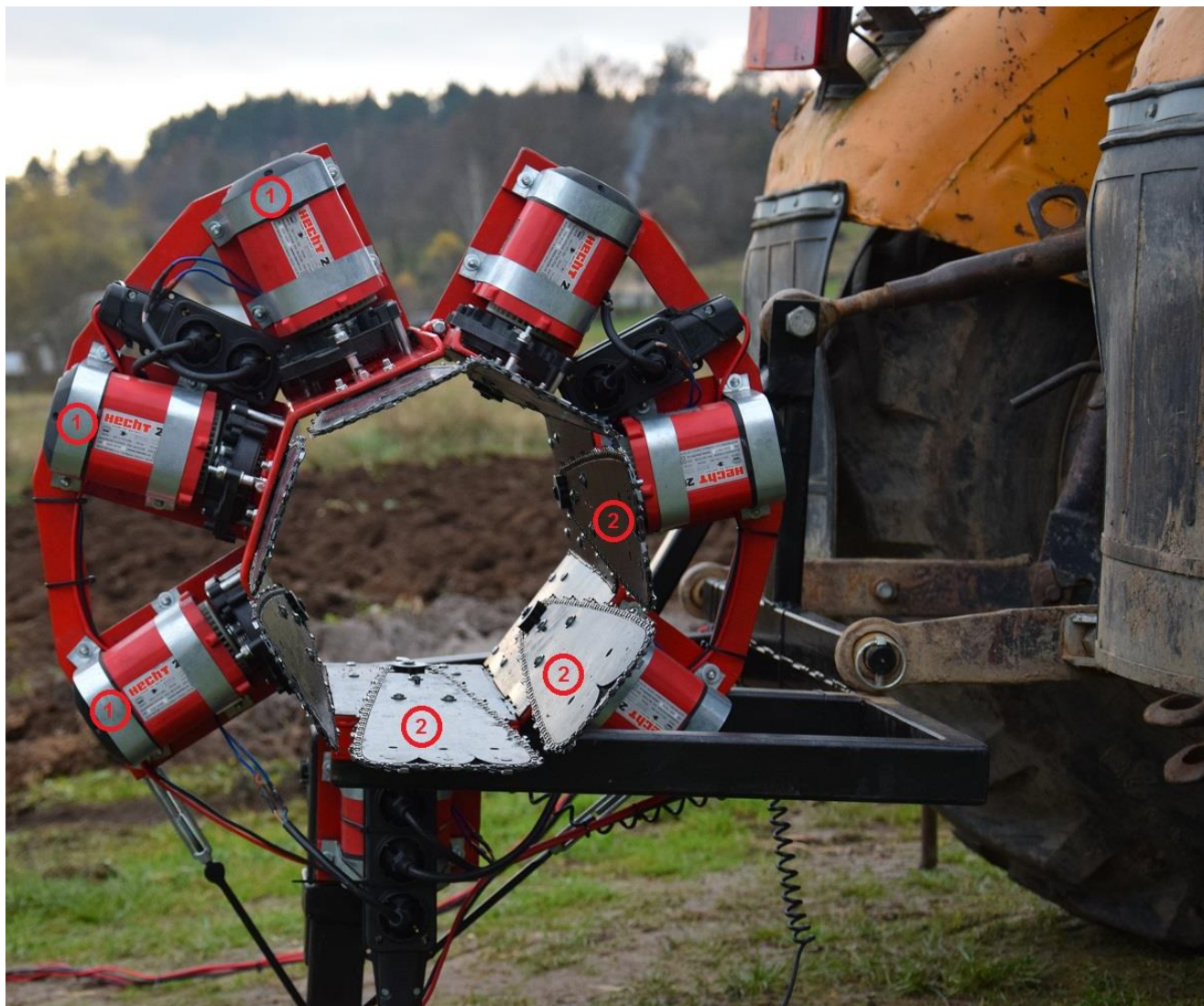
Ryc. 14. Widok zamkniętej głowicy okrzesującej aktywnie GO-01 od strony „wlotu” surowca drzewnego. Na rycinie widoczne silniki napędzające łańcuchy tnące (1) oraz prowadnice do łańcuchów tnących (2) (źródło: archiwum prywatne autora)
