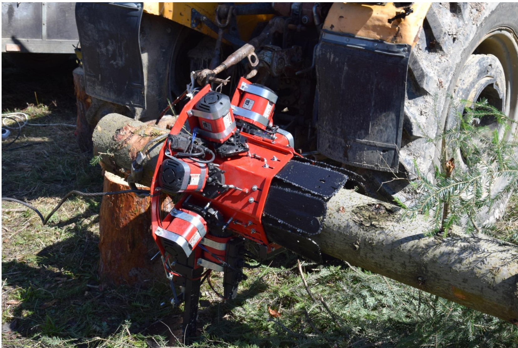
Ryc. 21. Przygotowanie prototypu głowicy okrzesującej GO-01 do pracy (jeszcze przed zetknięciem pił z pierwszym okółkiem gałęzi) (źródło: archiwum prywatne autora)
