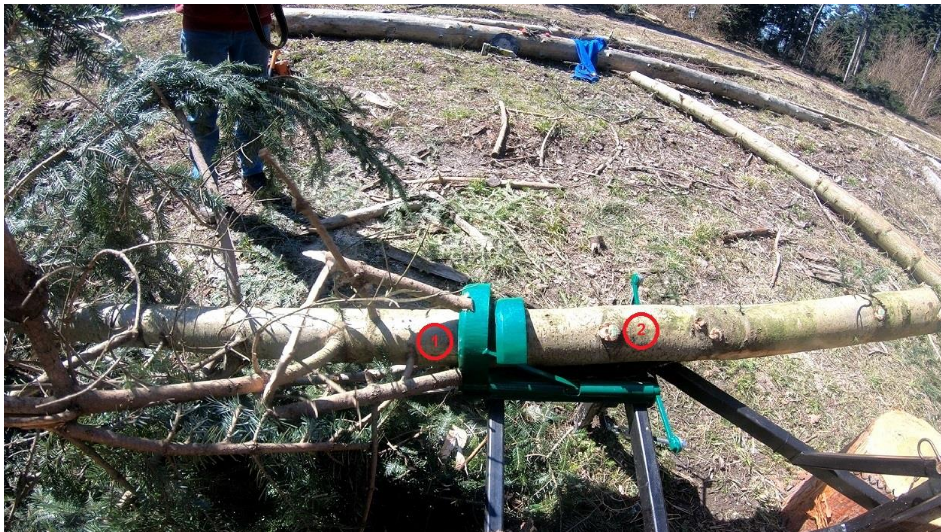
Ryc. 19. Głowica okrzesująca surowiec drzewny w sposób pasywny GO-02 podczas pracy. Na rycinie widoczne zarówno gałęzie będące w trakcie odcinania (1), jak i sęki po już odciętych konarach (2) (źródło: archiwum prywatne autora)
