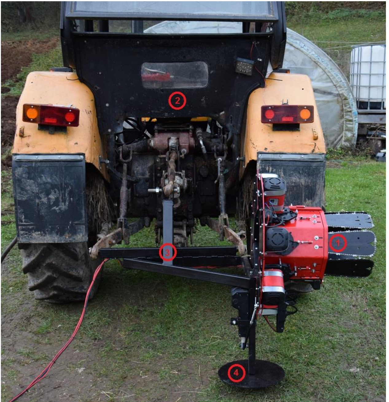
Ryc. 12. Prototyp głowicy okrzęsującej GO-01 (1), zamontowany na TUZ ciągnika rolniczego (2) za pośrednictwem dedykowanej ramy (3). Na rycinie widoczna także płyta oporowa (4) z kolcem zagłębionym w podłożu, zapobiegająca zapadaniu układu w gruncie o niskiej nośności (źródło: archiwum prywatne autora)
