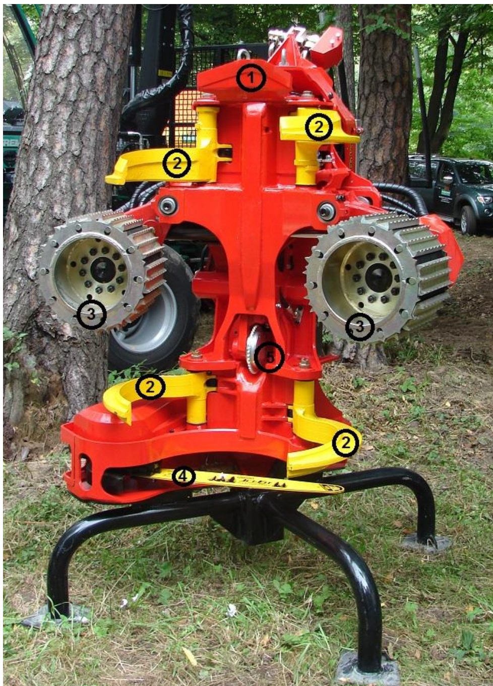
Ryc. 7. Opis budowy typowej głowicy do maszynowego pozyskiwania surowca drzewnego:
