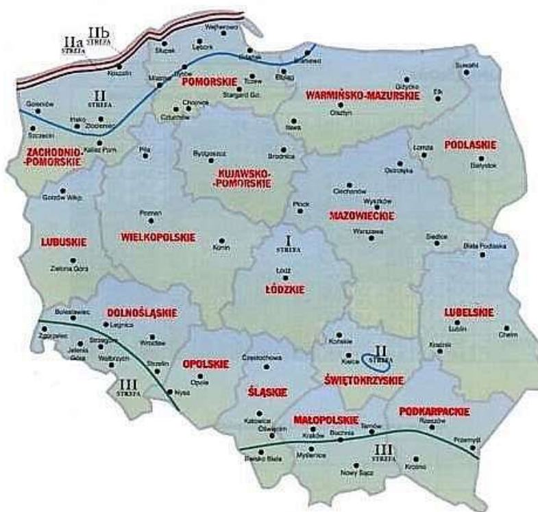
Ryc. 11. Strefy wiatrowe w Polsce [za: PN-77/B-02011 "Obciążenia w obliczeniach statycznych. Obciążenie wiatrem"]
